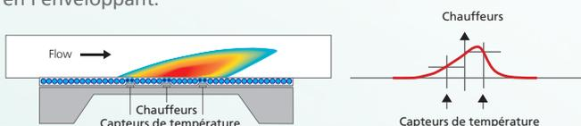
En haut de l'élément chauffant est ainsi formée une cloche de chaleur qui est ensuite déplacée par le flux d'air. A gauche et à droite de l'élément chauffant, deux capteurs de température mesurent la température du fluide. A partir des différences de mesure qui en résultent la vitesse normale est calculée. Là, où la zone la plus chaude est détectée, le capteur identifie la direction du flux (en option).
