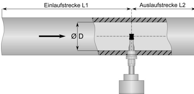
Die minimale Einlauf- und Auslaufstrecke ist abhängig von der Art des Strömungshindernisses vor der Messstrecke und dem Innendurchmesser  $D$  des Rohrs.
