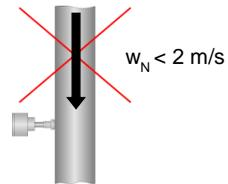
Korrekte Messwerte werden dann erst ab einer Strömungsgeschwindigkeit von 2 m/s ausgegeben (bei 16 bar).
