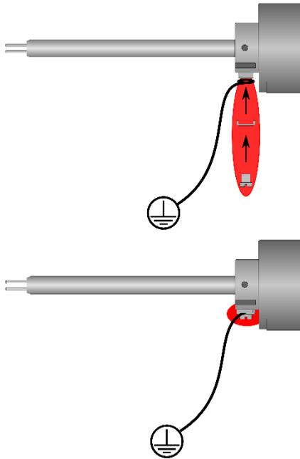
Abbildung 5-1 Erdungsanschluss (rot) bei Kompaktfühler
