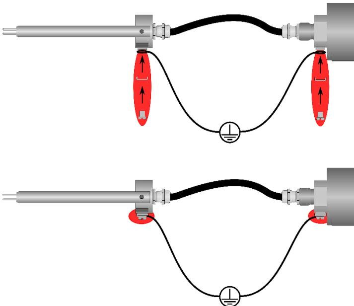
Abbildung 5-2 Erdungsanschlüsse (rot) bei abgesetzter Variante
