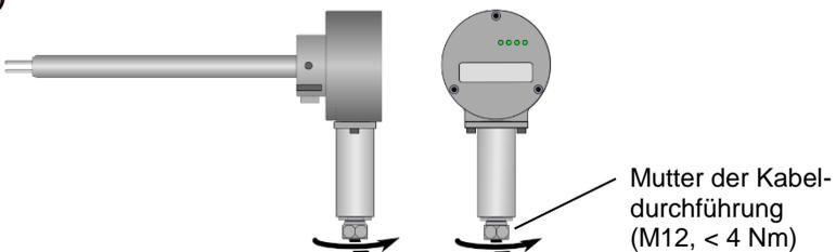
Abbildung 7-1 Montage Anschlusskabel mit Schutzhülse
