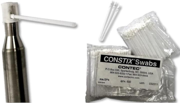
**Abbildung 8 Geeignete Wattestäbchen mit schmalen Reinigungspads**
