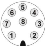
Abbildung 1: Blick auf Stecker vom Sensor (male)
